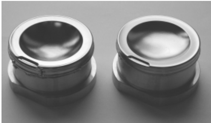
Mit Nickelphosphor galvanisch beschichtete Formwerkzeuge für optische Linsen
